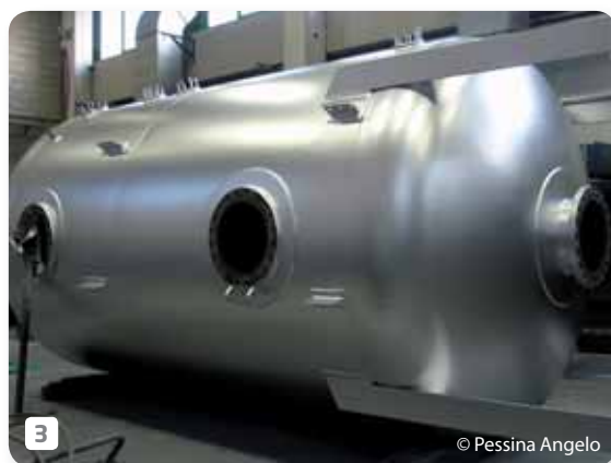
3 Exterior view of one of the exchangers coated for SESPI Srl. Esterno di uno degli scambiatori rivestiti per SESPI Srl.
